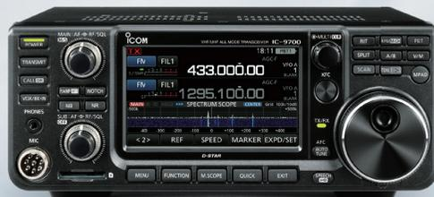
144MHz+430MHz+1200MHz<SSB/CW/RTTY/AM/FM/DV/DD>50Wトランシーバー
